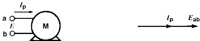
Gambar 10 : Motor sinkron dengan faktor daya unity dan diagram fasor pada beban penuh
